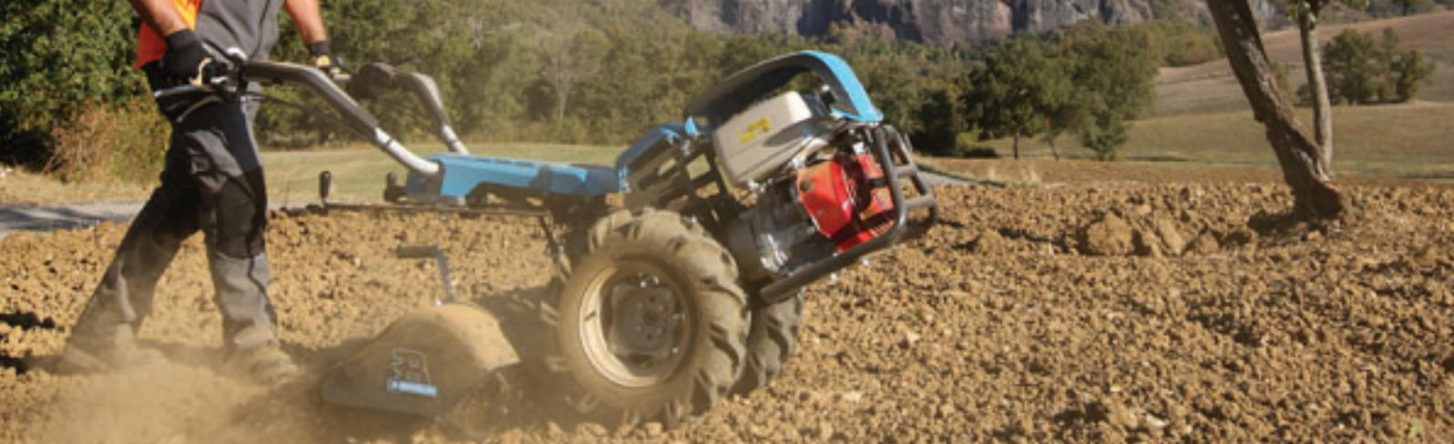
Il sistema di attacco rapido QuickFit consente di cambiare le attrezzature in modo semplice e rapido, senza l'utilizzo di chiavi.
